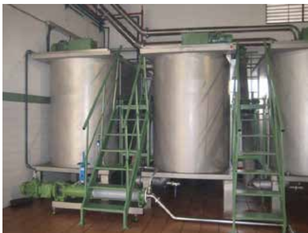
Čerpadlo DN Používá se pro přenos buničiny / olivové pasty.
