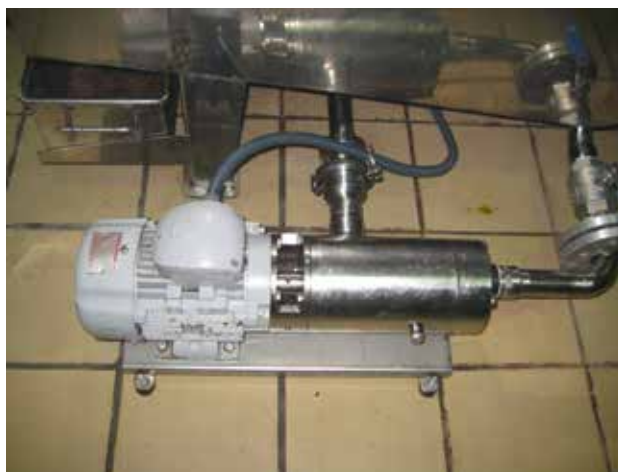
Čerpadlo R s plovoucím statorem Pro čerpání zeleninových šťáv.
