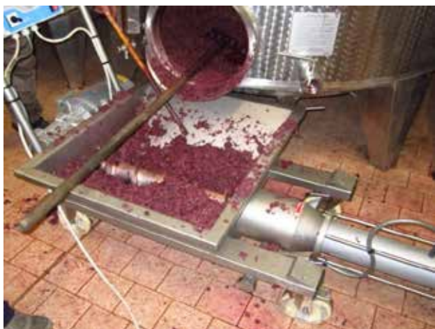
Čerpadlo DHE Přenos fermentovaných výlísků
